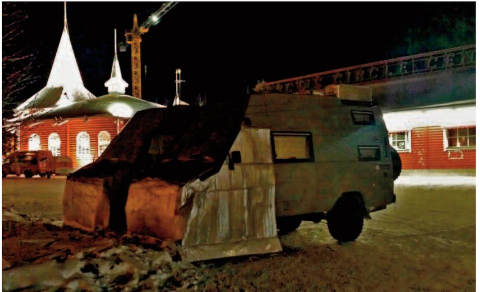
terna decisamente superiore, si avverte senza bisogno di misurarla con gli strumenti. Larcos, anzi, ha progettato per le nostre specifiche esigenze, due coperture fuori standard anche nella lunghezza, portando il cappotto Overcoat a coprire, oltre a tutto il muso del veicolo, anche le ruote, al fine di impedire all'ac-
