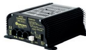
Il convertitore DC/DC NE325 è adatto per ricaricare la batteria ausiliaria attraverso l'alternatore. Nel caso di batterie al litio, che hanno la resistenza interna praticamente nulla, il DC/DC è invece necessario per limitare la corrente di carica dell'alternatore e per proteggere quindi l'impianto da surriscaldamenti o danneggiamenti.
