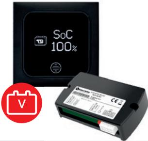
PANNELLO TEST DIGITALE TOUCH con display OLED per la lettura dello stato di carica (%) delle batterie litio e tradizionali. Visualizzazione dello stato di carica (SoC), tensione di batteria e della corrente -150A + 150A. Con regolazione della luminosità minima. Completo di shunt e cavo L=5m. Versione da incasso o da parete con distanziale in dotazione.
